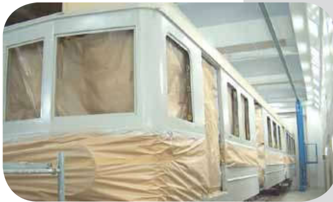
Easy access to plenum filters replacement Leichter Zugang um die Plenum Filter zu erneuern Accès facile au remplacement des filtres du plenum
